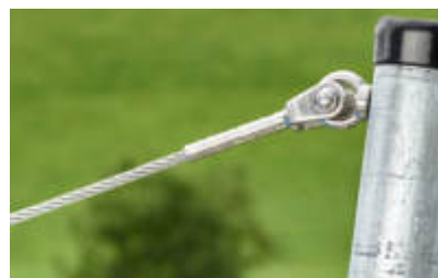
Akupresse EKM 6022 CL zum Verpressen von Endverbindungen vor Ort, auch leihweise erhältlich.
