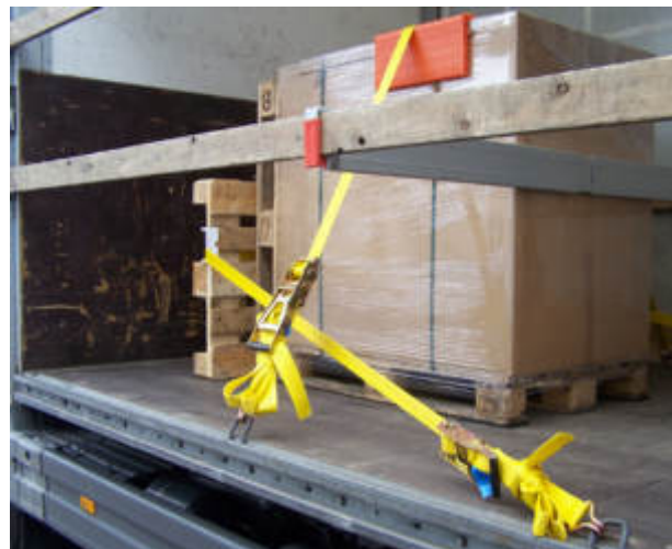
Kombination aus Kopf-Lashing und Niederzurrung
